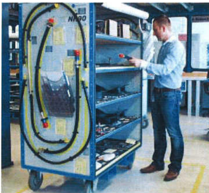
Mit eigens entwickelten Taktwagen wurde bei Eurocopter die Materialbereitstellung revolutioniert. Dabei handelt es sich um fahrbare Handwagen mit offenen Regalfächern
