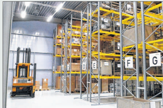
Im August 2012 sind die Hochregale bereits bestückt und der Schmalgangstapler steht zur Arbeit bereit.
